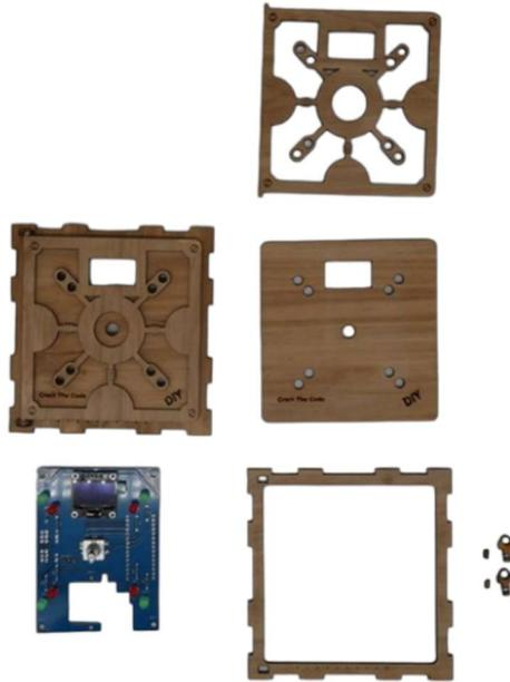
Zunächst steckt man die Platine oder, falls man diese nicht verwenden möchte, lediglich die LEDs in die dafür vorgesehenen Öffnungen an der Tür. Diese dienen als Zentrierungshilfen beim Aufkleben des Zierpanels. Dann bringt man den Klebstoff auf dem Zierpanel auf und legt es auf der Tür auf. Nach dem Entfernen der Platinen bzw. der LEDs kann man diese unter Verwendung von Schraubzwingen und der Bodenplatte fest zusammendrücken.
